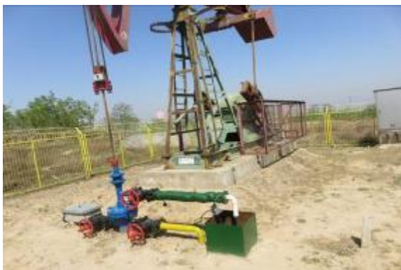
平台采出水收集（槽下地下管线入污水池）
